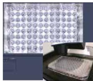
サンプルをセットするだけで自動的にサンプルを認識します。さらに自動的にオーバービュー画像を作成します
